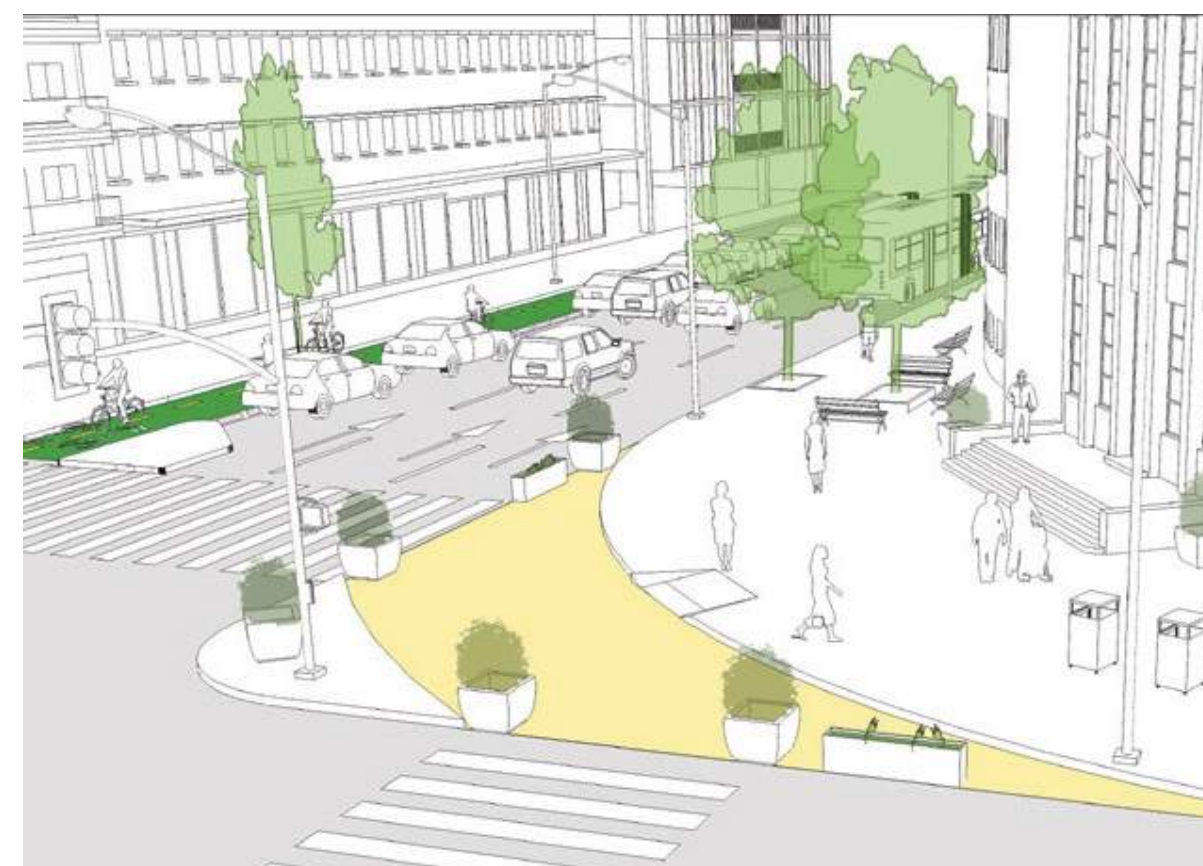
Slip Lane Removal / Eliminación de Carril de Desaceleración
